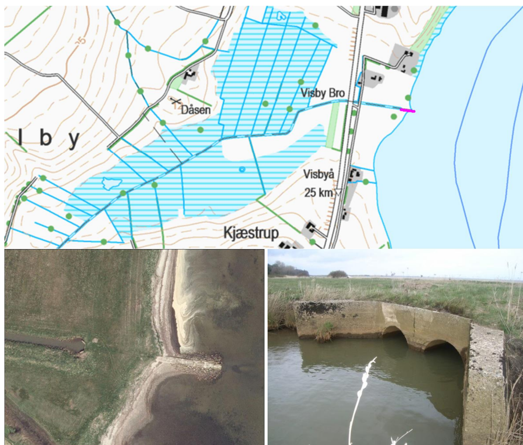
Figur 1.1: Rørlægning AAL-1166, projekt 1- Sydthy. Visby Å er rørlagt de sidste 55 m inden udløbet i Limfjorden.
